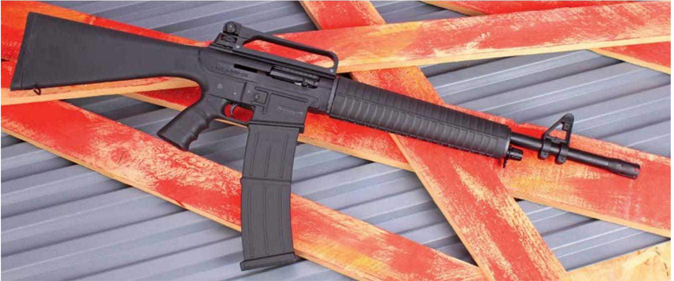
Die Akdal-Flinte von rechts (o.) mit dem langen Magazin und dem originalen Tragegriff. Und von links (u.) mit kürzerem Magazin und dem von Waffen Schumacher gelieferten und sichtlich zierlicheren Ersatztragegriff vom Typ UTG MNT-950 Model 4/15.
